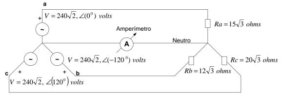
A corrente indicada no amperímetro de ferro móvel é igual a
